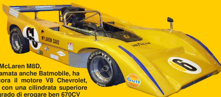
La McLaren M8D, chiamata anche Batmobile, ha ancora il motore V8 Chevrolet, ma con una cilindrata superiore in grado di erogare ben 670CV
