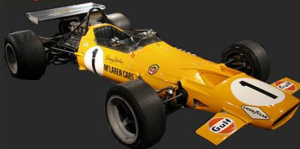
**Telaio:** monoscocca composto da profilati in alluminio L72 Reynolds e da pannelli di magnesio rivettati. I fianchi contenevano due serbatoi di benzina in plastica della capacità di 50 litri, un altro supplementare di 40 litri dietro il sedile e un altro sopra le gambe: in tutto 145 litri. Il radiatore dell'acqua della Sek era posto all'anteriore mentre quello dell'olio era piazzato proprio sopra il cambio.
