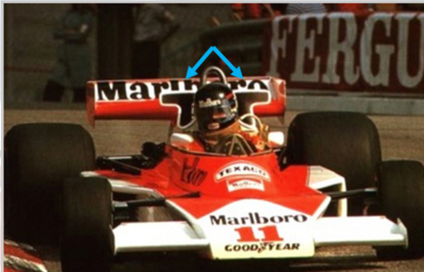
Dal Gran Premio di Spagna, a seguito dei nuovi regolamenti introdotti dalla Federazione Internazionale, via gli air-scoop sopra il roll-bar, sostituiti da prese dinamiche laterali che ciascuno interpreta in maniera diversa. La McLaren le colloca di fianco al roll-bar, la Ferrari ai due lati dell'abitacolo.
